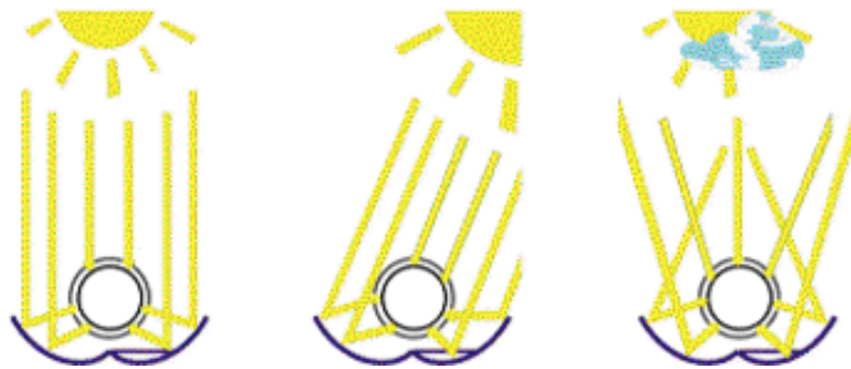
Figura 6 - Formas de captação solar de um coletor concentrador parabólico.[17]
